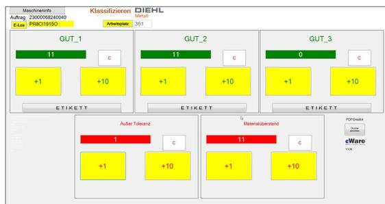
Für die Nachkontrolle von Teilen wurde eine Möglichkeit gesucht komfortabel die Eingangscharge auf mehrere Ausgangslose und Ausschusslose zu verteilen. Die
